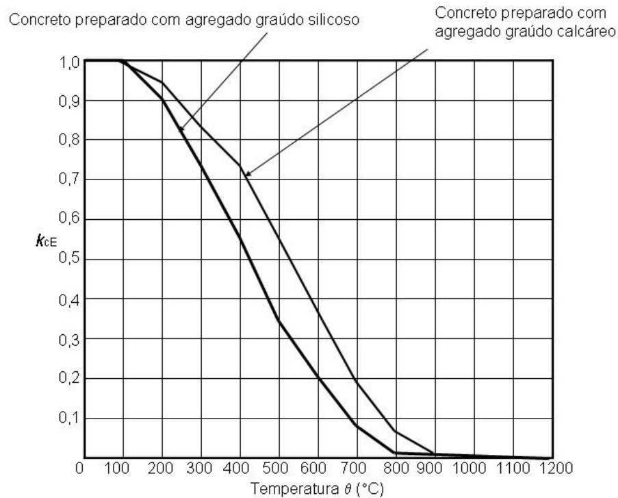
Figura 2 — Fator de redução do módulo de elasticidade do concreto em função da temperatura
